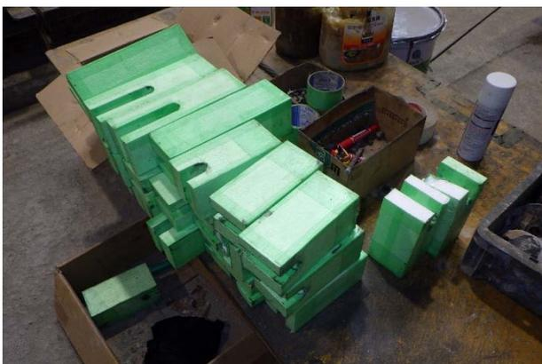
写真-4 箱抜き材(外枠材)の拡大写真
