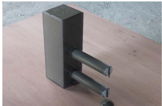
写真-18 無収縮モルタル充填確認試験
