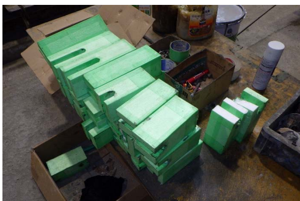
写真-4 箱抜き材(外枠材)の拡大写真
