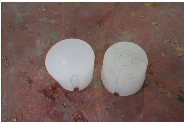
写真-14 プラスチック栓の拡大写真
