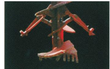
掘削拡大ビットA型
