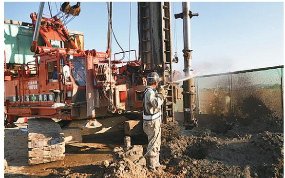
未固結試料採取装置
