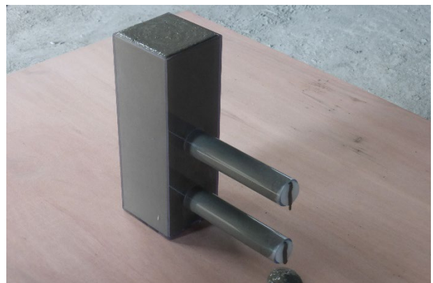
写真-9 無収縮モルタル充填確認試験状況
