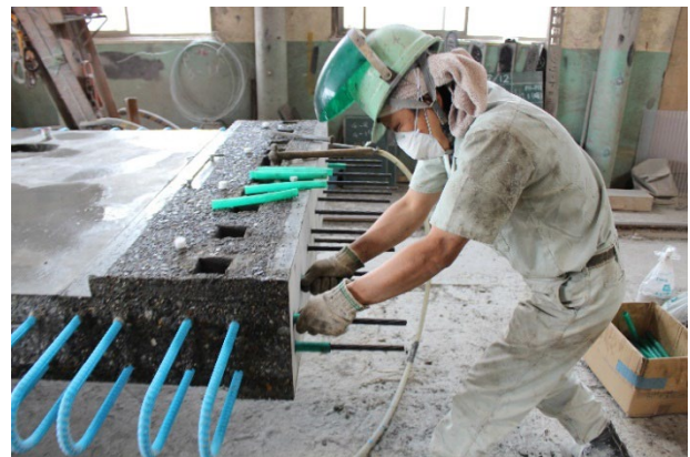
写真-5 ボンドレス用ホースの撤去
