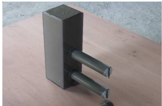
写真-9 無収縮モルタル充填確認試験状況
