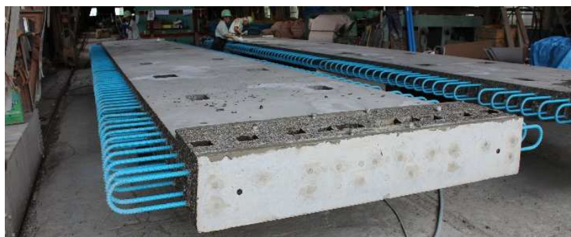
写真-1 充填材の後打ち完了 (床版側面)
